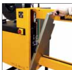
Accessibilité optimale, pas d'outils nécessaires pour la maintenance
