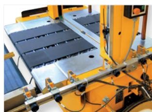
**Fotocellule - Seconda tensione della reggia / Controllo altezza pacchi**
